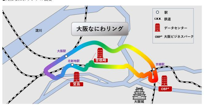
JRWON が保有する鉄道用の光ファイバールートと BB バックボーンが持つ光ファイバーに関するナレッジを活用して、新たに建設された大阪ビジネスパークデータセンター(所在地:大阪府京橋エリア)と、大阪市内の主要データセンターが集積する堂島や曽根崎を接続する光ファイバーネットワークです。BB バックボーンと JRWON は、2023 年初めに「大阪なにわリング」の提供開始を予定しています。
